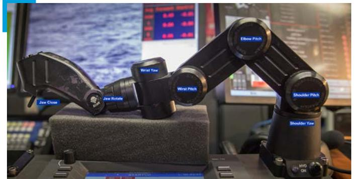
Los pilotos del ROV utilizan este modelo a escala para controlar el brazo de manipulación de D2 cuando recogen una muestra. Imagen cortesía de Art Howard, GFOE; editada por Jeffery Laning, GFOE.
