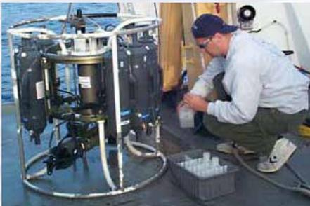
Se amarra un CTD a una estructura metálica llamada roseta, o carrusel, junto con numerosas botellas de muestreo de agua y cuando se despliega, proporciona información sobre la composición de la columna de agua. Imagen cortesía de NOAA.
