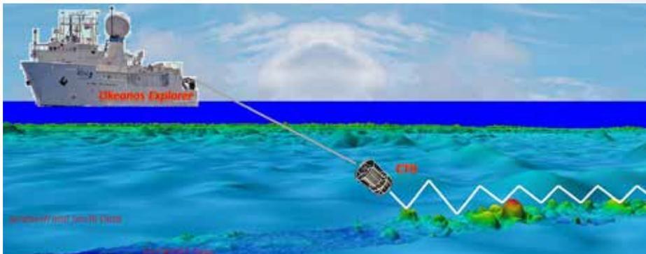
Esta imagen ilustra el concepto de un Tow-Yo de CTD. Se sumerge el CTD a menos de 20 metros del fondo del mar, y luego se lo cicla entre cerca del fondo y 300 metros sobre el fondo marino (como un yoyo), ya que es remolcado detrás del barco. Los datos del sensor se registran y monitorean continuamente para encontrar signos de la presencia de penachos de respiraderos hidrotermales. Imagen: Programa *Okeanos Explorer*, NOAA.
